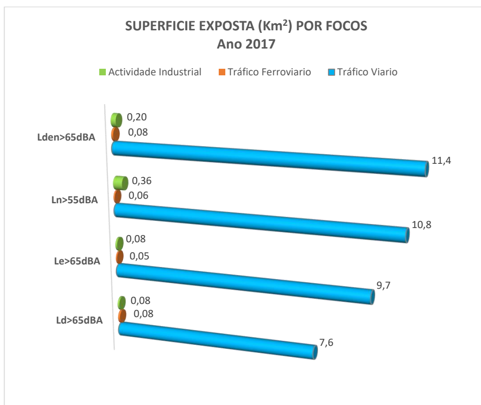
Gráfica 21. Superficie total de Vigo (Km 2 ) exposta en 2017 a niveis L d >65dBA, L e >65dBA, L n >55dBA e L den >65dBA, debidos a cada fonte de ruído individual
