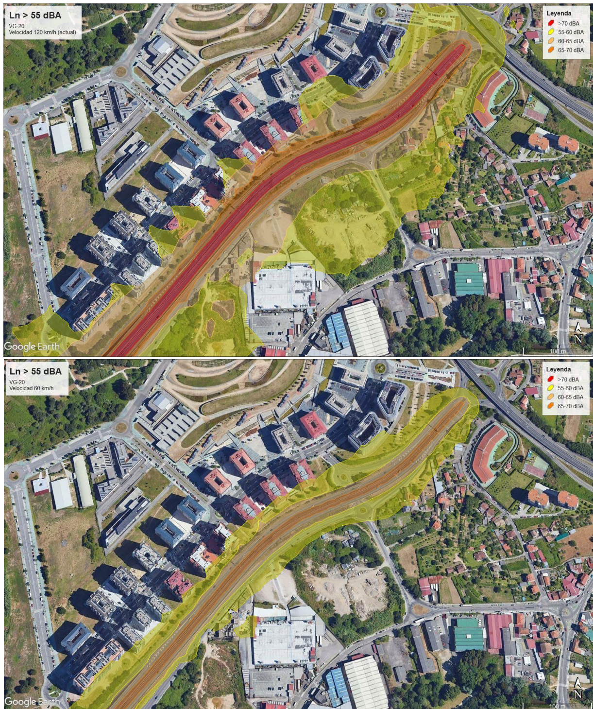
Figura 15. Niveis de ruído nocturno Ln>55 dBA en VG-20. Arriba, situación actual; abaixo, efecto de reducir a velocidade
