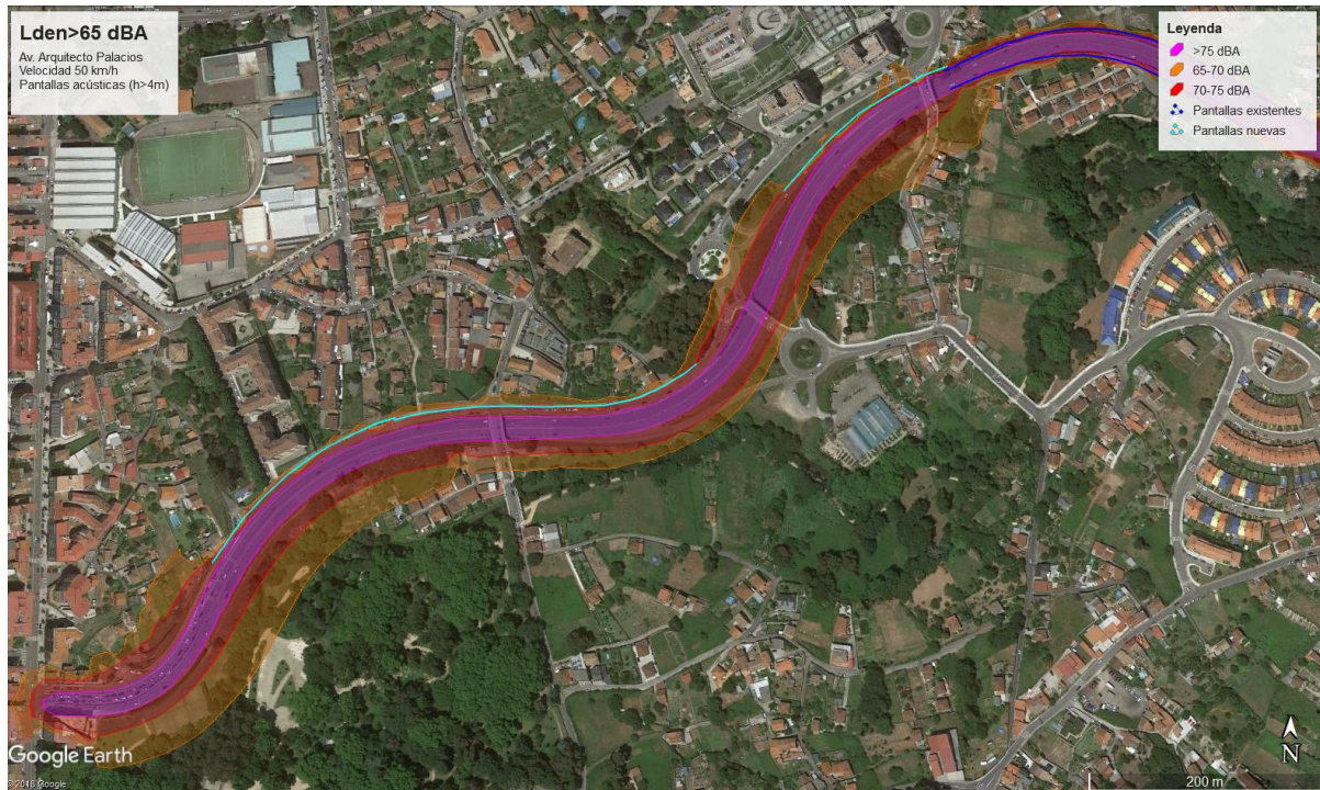
Figura 20. Niveis de ruído global L_{den} > 65 dBA debidos exclusivamente á Av. Arquitecto Palacios, tras reducir a velocidade e aplicar novas pantallas acústicas
