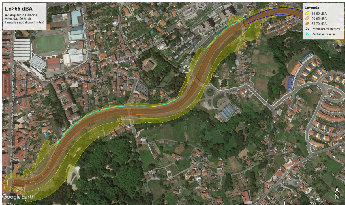
Figura 21. Niveis de ruído nocturno L_n > 55 dBA debidos exclusivamente á Av. Arquitecto Palacios, tras reducir a velocidade e aplicar novas pantallas acústicas
