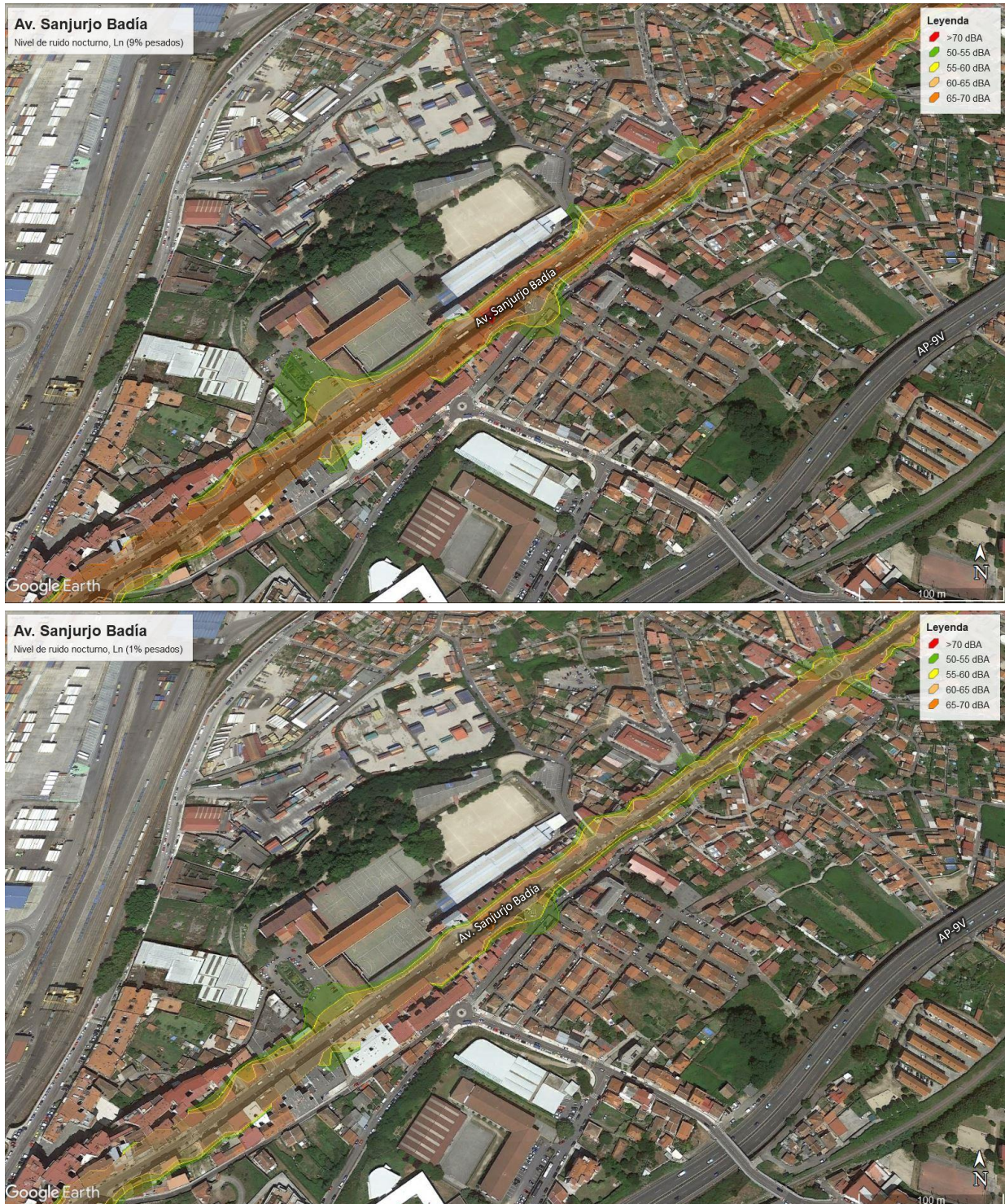
Figura 33. Niveis de ruído nocturno L n >55 dBA en Av. Sanjurjo Badía. Arriba, con 9% de vehículos pesados circulando (ano 2013); abaixo, con 1% de vehículos pesados circulando (ano 2018)
